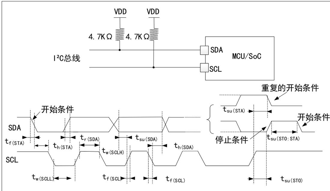
注意：测量点设置于 CMOS 电平： $0.3V_{DD}$  和  $0.7V_{DD}$ 。
