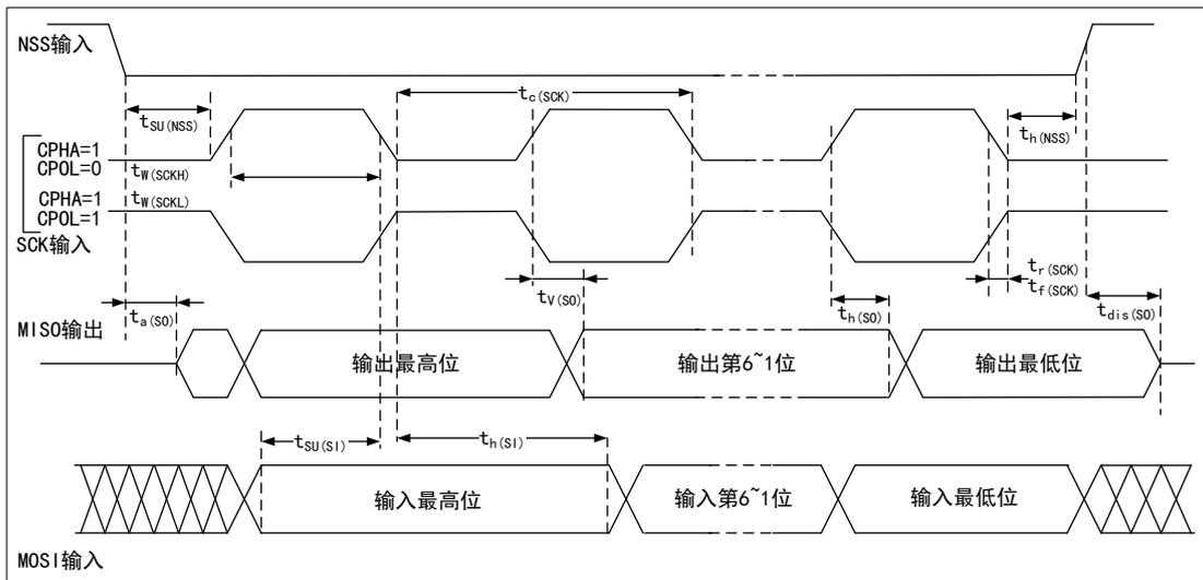
注意：测量点设置于 CMOS 电平：0.3V<sub>DD</sub> 和 0.7V<sub>DD</sub>。
