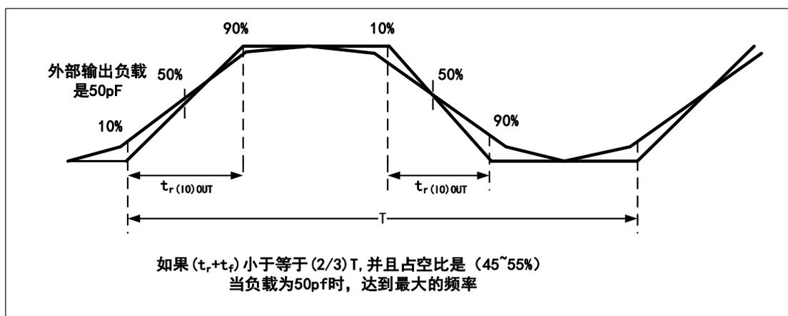
表格 45 输出驱动电压特性( $T_A=25^\circ C$ )
