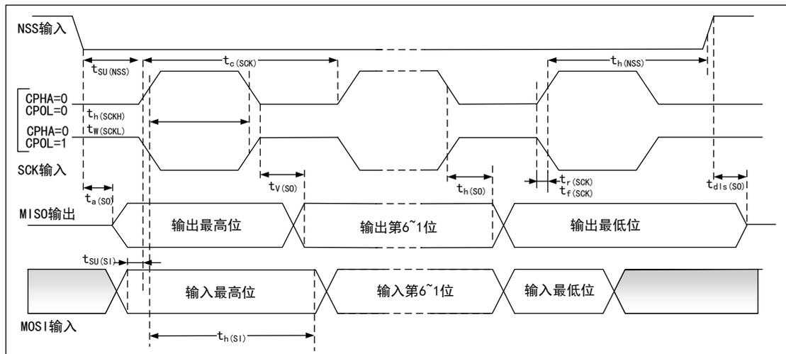
图 14 SPI 时序图—从模式和 CPHA=1
