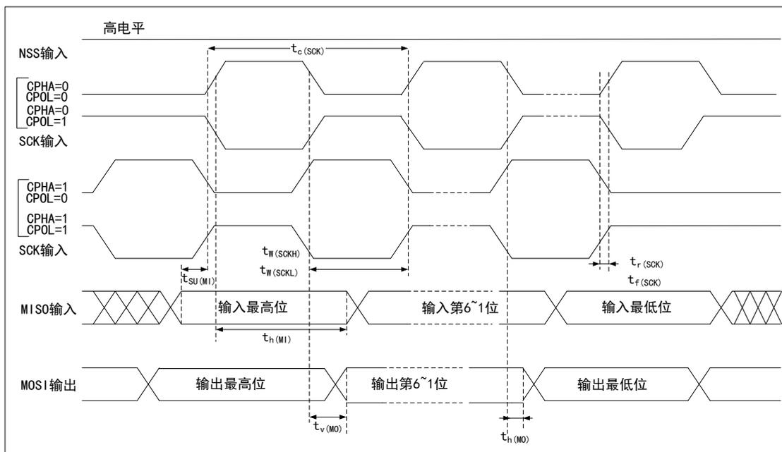
注意：测量点设置于 CMOS 电平：0.3V<sub>DD</sub> 和 0.7V<sub>DD</sub>。
