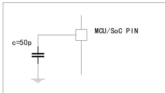
图 9 引脚输入电压测量方案
