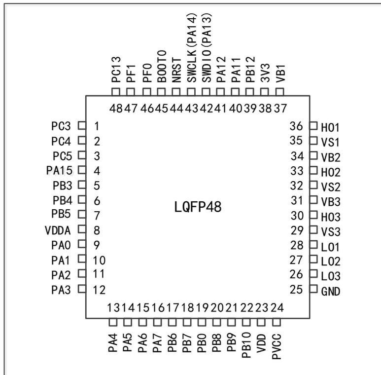
图 3 APM32M3514x8 产品 QFN48 引脚配置图
